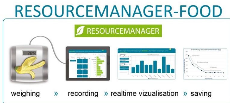
Σχηματική περιγραφή της λειτουργίας του συστήματος RMF
